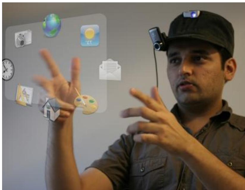
Εικόνα 1.24 Το WUW (MIT) παρέχει πληροφορίες που προβάλλονται σε διάφορες επιφάνειες μέσω φυσικών χειρονομιών
