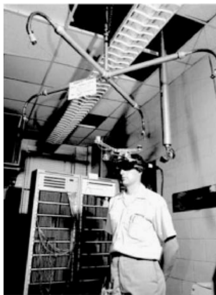
Εικόνα 1.1 Το σύστημα "The Sword of Damocles" του Ivan Sutherland
