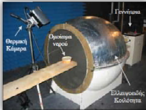
Εικόνα 4.4: η διάταξη για τα πειράματα της υπερθερμίας
