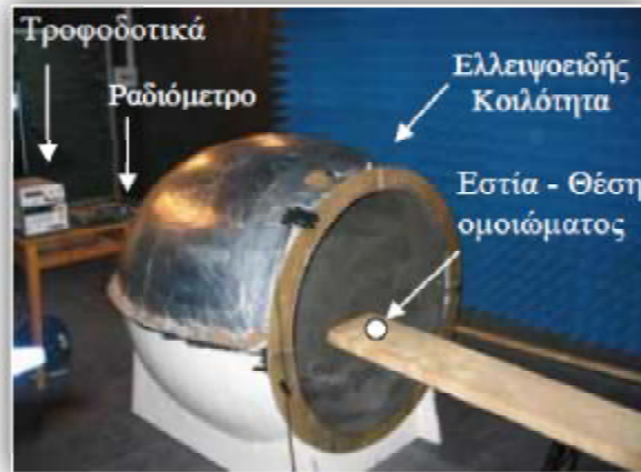
Εικόνα 4.5: Τα κύρια τμήματα του συστήματος κατά τη φάση λειτουργίας της ραδιομετρίας
