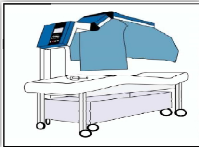
Εικόνα 3.5: Σχηματικό διάγραμμα του συστήματος “Iraetherm” για γενική υπερθερμία.
