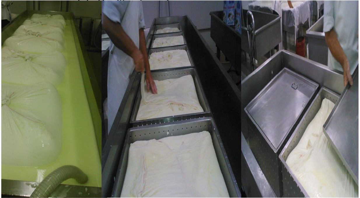
ΕΙΚΟΝΑ 20: Τοποθέτηση τυροπήγματος σε ανοξείδωτα καλούπια
