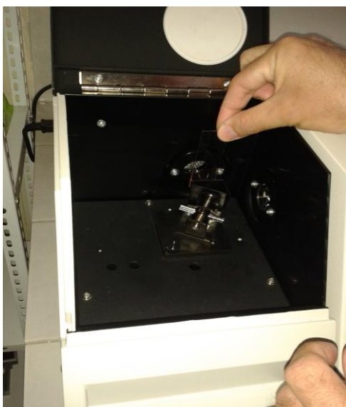
Εικ. 31: Εισαγωγή του επεξεργασμένου γυαλιού μικροσκοπίου στο ειδικό μηχάνημα ελέγχου φθορισμού στο εργαστήριο.
