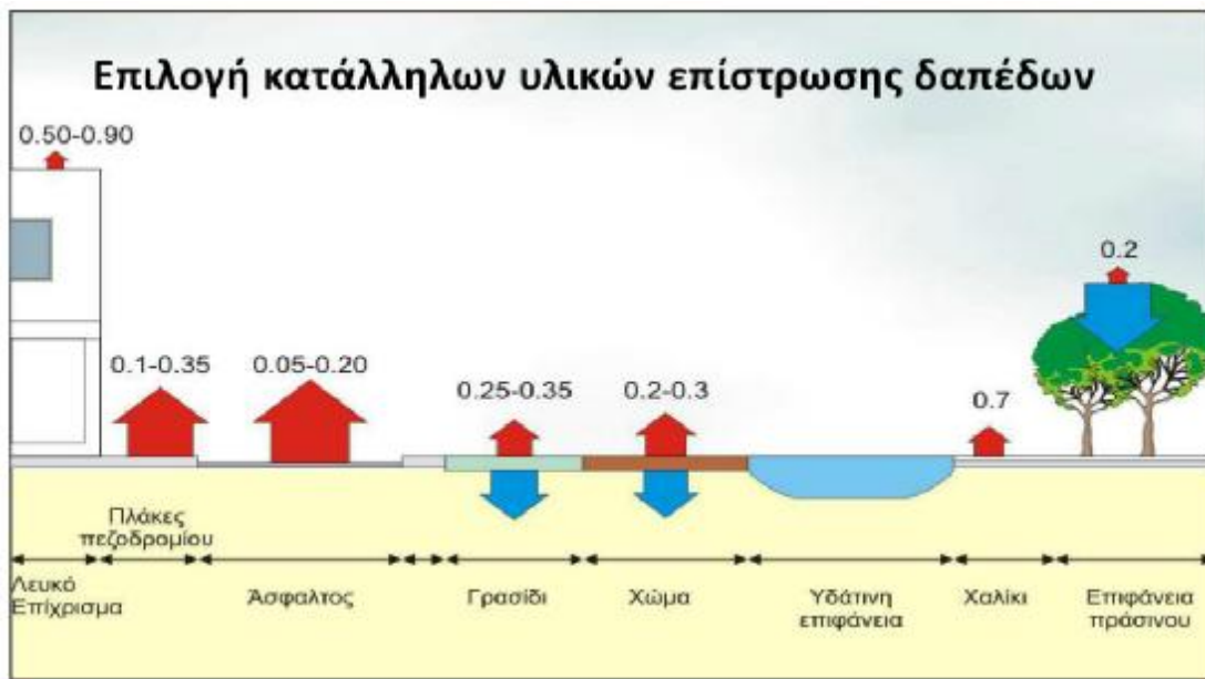
Εικόνα 6.4 : Ακτινοβολούμενη θερμότητα από υλικά επίστρωσης δαπέδου
