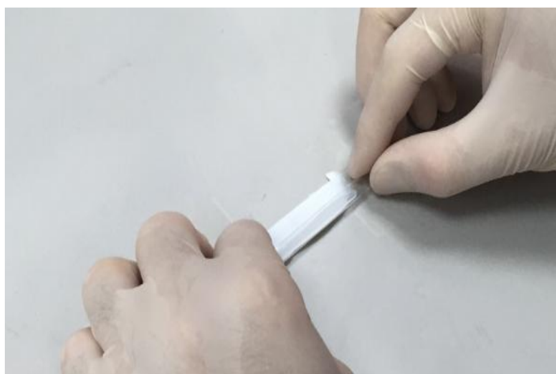
Εικόνα 6.9 : Παρασκευή φωτοκαταλυτικών υμενίων με τη μέθοδο doctor blade (Kontos et. al., .2011).
