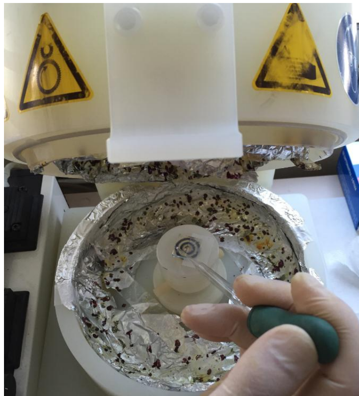
Εικόνα 6.29 : Εναπόθεση σταγόνων του διαλύματος \text{TiO}_2 στο αγώγιμο γυαλί TEC8.
