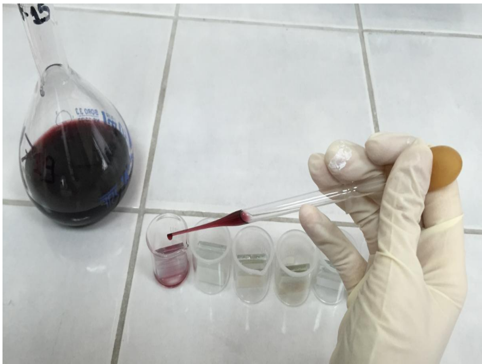
Εικόνα 6.36 : Εναπόθεση της χρωστικής N719 με τη χρήση πιπέτας στα πορσελάνινα γουδιά.
