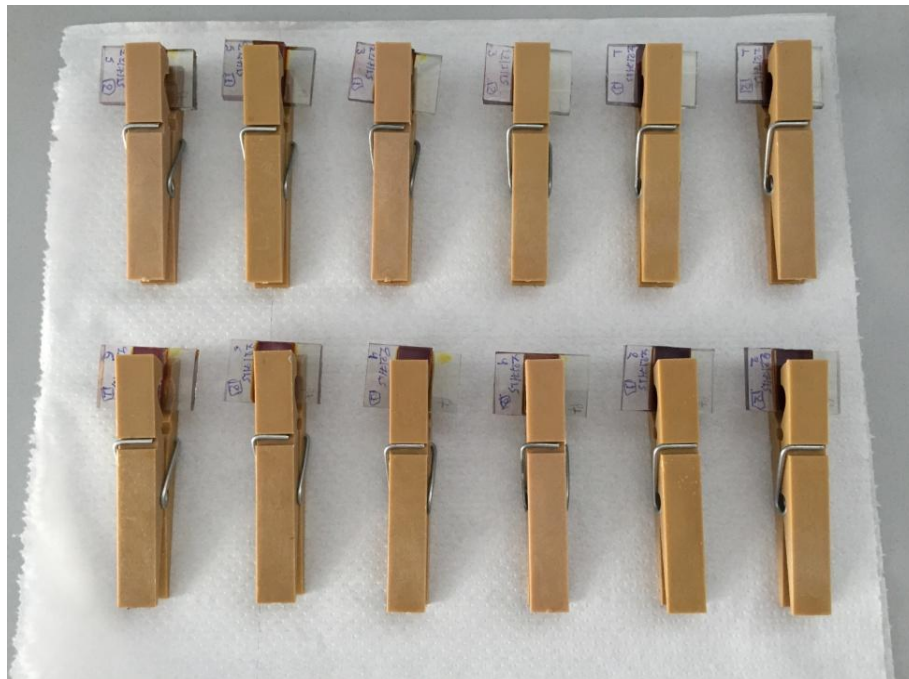
Εικόνα 6.42 : Σφράγισμα των φωτοευαίσθητων ηλιακών κυψελίδων με πλαστικούς συνδετήρες.
