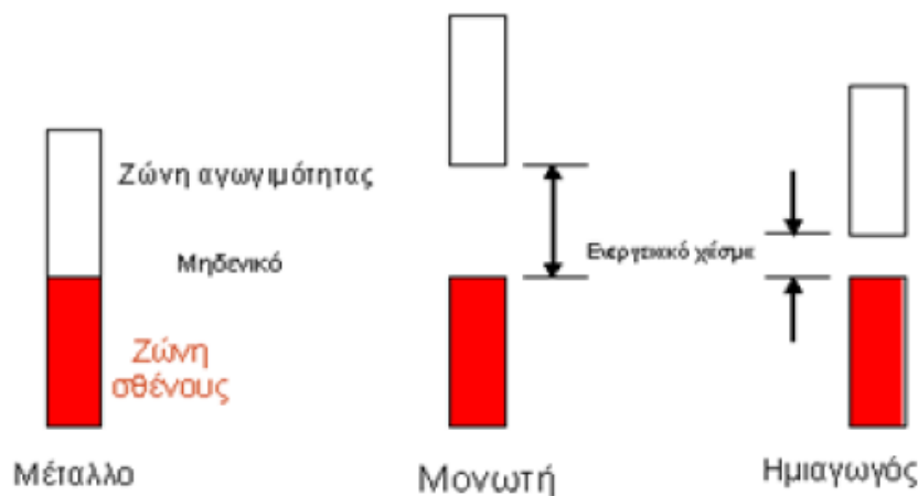
Σχήμα 2.3 : Διάγραμμα ενεργειακών ζωνών για μέταλλο, μονωτή και ημιαγωγό (Τρυπαναγνωστοπούλου, 2010).
