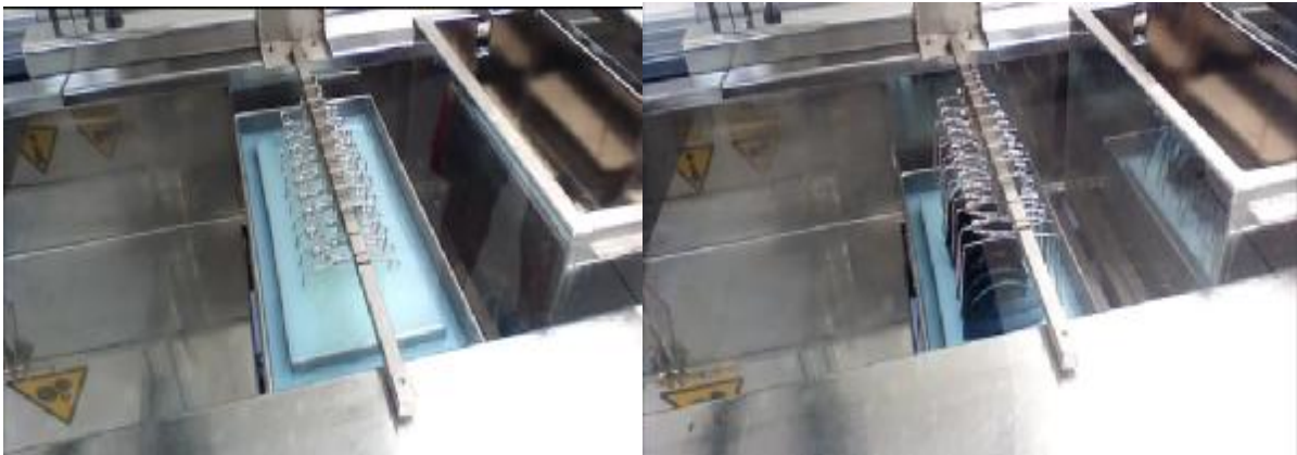
Εικόνα 2.2: Εμβάπτιση φακών στο αντιχαρακτικό βερνίκι
