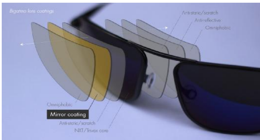
Εικόνα 2.7: Ανάλυση ανακλαστικής επίστρωσης
