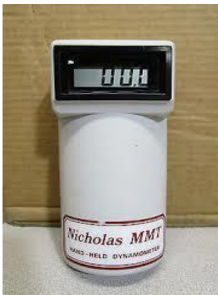
Εικόνα 2.1.1.2. Δυναμόμετρο χειρός Nicholas MMT Lafayette (τροποποιήθηκε από: https://www.google.gr/search?q=nicholas+lafayette&source=lnms&tbn=isch&sa=X&ved=0ah
