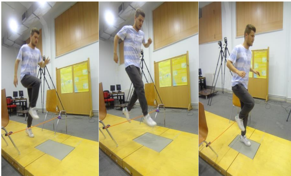
Εικόνα 2.3.6.1. Υπερήδηση εμποδίου και προσγείωση στο δυναμοδάπεδο για ανάλυση της εμβιομηχανικής της προσγείωσης έπειτα από κόπωση γαστροκνήμιου μύος
