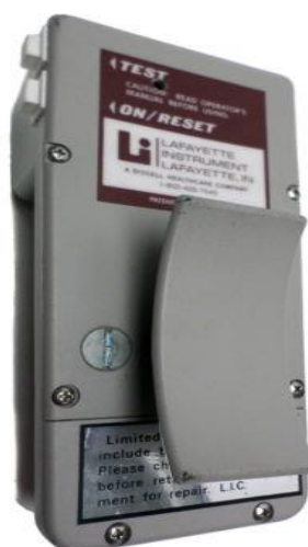
Εικόνα 2.1.1.2. Δυναμόμετρο χειρός Nicholas MMT Lafayette (τροποποιήθηκε από: https://www.google.gr/search?q=nicholas+lafayette&source=lnms&tbn=isch&sa=X&ved=0ah
