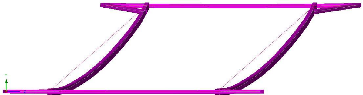
Εικόνα 6.12: Παραμόρφωση στην κύρια δοκό.
