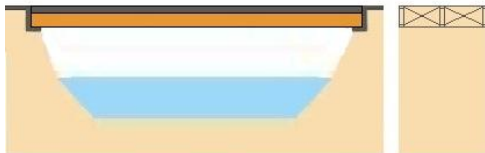
Εικόνα 2.24: Γέφυρα μορφής δοκού, το κατάστρωμα είναι πάνω στις δοκούς.
