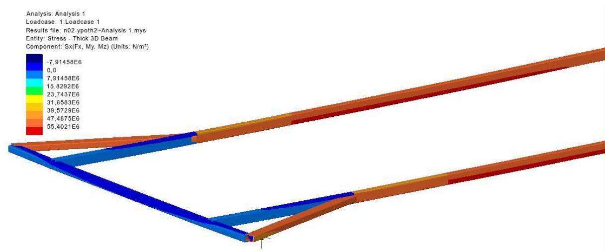
Εικόνα 6.37: Οι τάσεις στο άλλο άκρο της κύριας δοκού, ελευθερία στον X άξονα.
