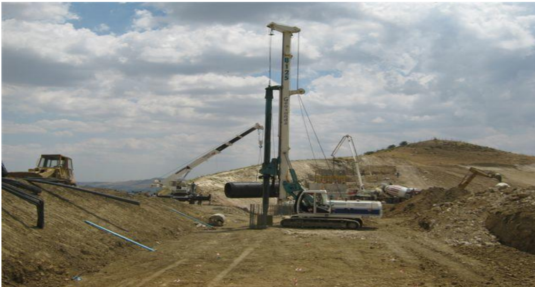
Εικόνα 1.6: Μάρκα CASAGRANDE Μοντέλο B125 Κινητήρας Cummins QSB 6.7, ισχύς - 162 kW (220 ίπποι) [44].
