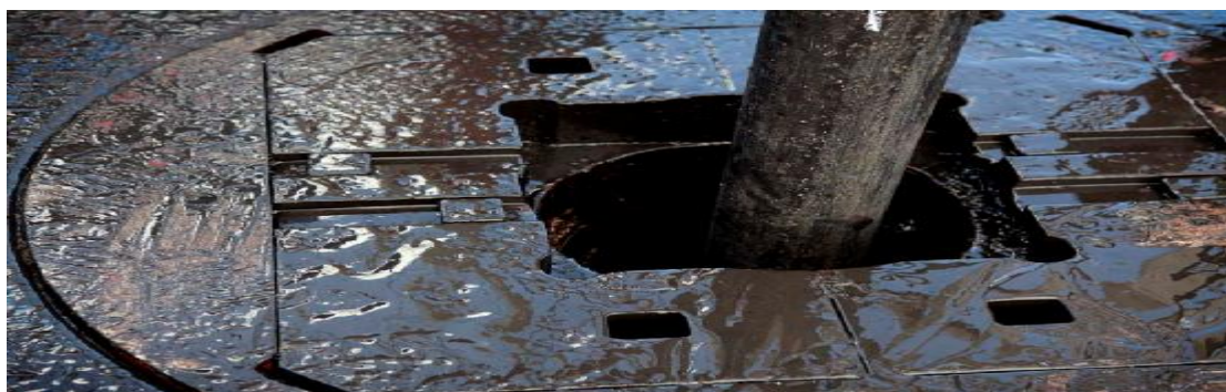
Εικόνα 2.9: Λάσπη με βάση το πετρέλαιο [17].
