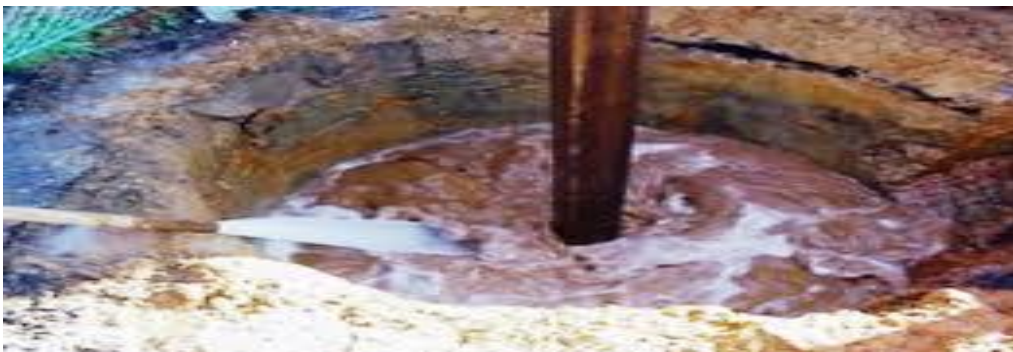
Εικόνα 2.8: Λάσπη με βάση το νερό [45].
