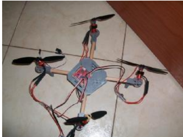
Σχήμα 6.1.13 : Λίγο πριν την στερέωση των εξαρτημάτων μας δείχνουμε πως θα τα τοποθετήσουμε πάνω στο σκελετό του τετρακοπτέρου
