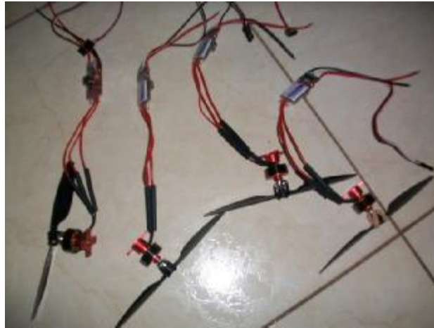
Σχήμα 6.1.11 : Οι τέσσερις διατάξεις στις οποίες είναι συδεδεμένα με τη σειρά ESC-H/K-έλικες.
