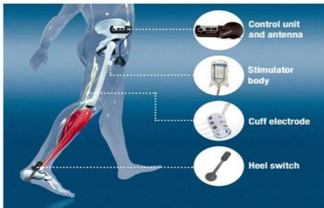
Εικόνα 3.5 Τοποθέτηση 4-channel FES
