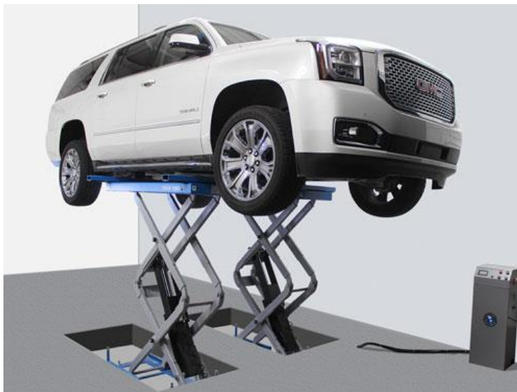
Σχήμα 1.12: «In ground» ψαλιδωτός ανυψωτήρας (Atlas FM9SL). [vii]
