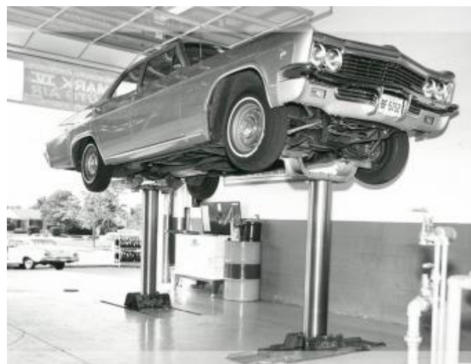
Σχήμα 1.2: Ενδοδαπέδιος (in ground) ανυψωτήρας αυτοκινήτου. [i]
