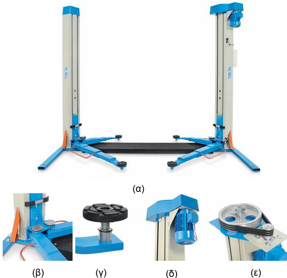
Σχήμα 1.15: α. Δικόλωνος ανυψωτήρας 3,2t με οδηγό αλυσίδα (3,3kW) (ART.199/UE - OMCN), β. Περιστρεφόμενοι βραχίονες, γ. τακάκια (pads) δ. Ηλεκτροκινητήρας, ε. Ιμαντοκίνηση [iv]
