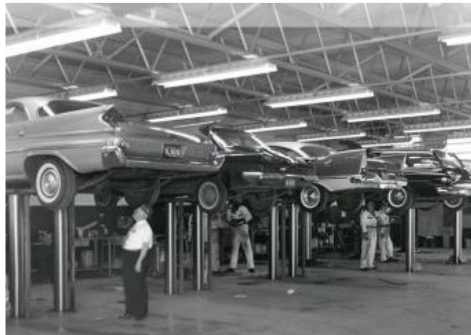
Σχήμα 1.1: Ενδοδαπέδιοι (in ground) ανυψωτήρες αυτοκινήτου. [i]
