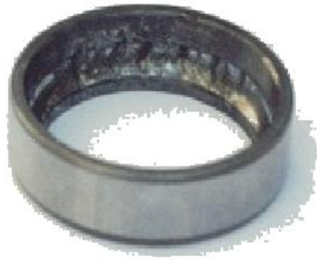
Σχήμα 3.4: Ρουλεμάν με φθορά στον εξωτερικό δακτύλιο
