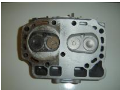
Εικόνα 2 Μηχ. εξάρτημα πριν και μετά την αμμοβολή [9]
