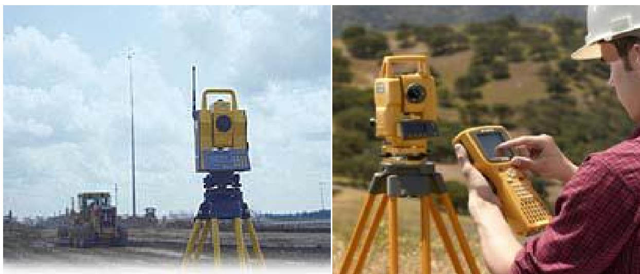
Εικόνα 1.1 Ρομποτικοί θεοδόλιχοι (RTS) Trimble 5600 και β) ρομποτικός θεοδόλιχος της Topcon (source: προσωπικό αρχείο)
