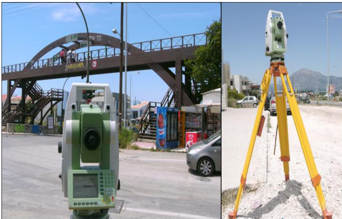
Εικόνα 1.5: Σημείο τοποθέτησης RTS σε σχέση με τη γέφυρα. (source: προσωπικό αρχείο)
