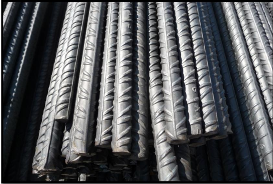
Εικόνα 1.3 : Εργοστασιακός χάλυβας που χρησιμοποιείται για τον οπλισμό τοίχων αντιστήριξης. Προσφέρει στην εφελκυστική αντοχή της κατασκευής
