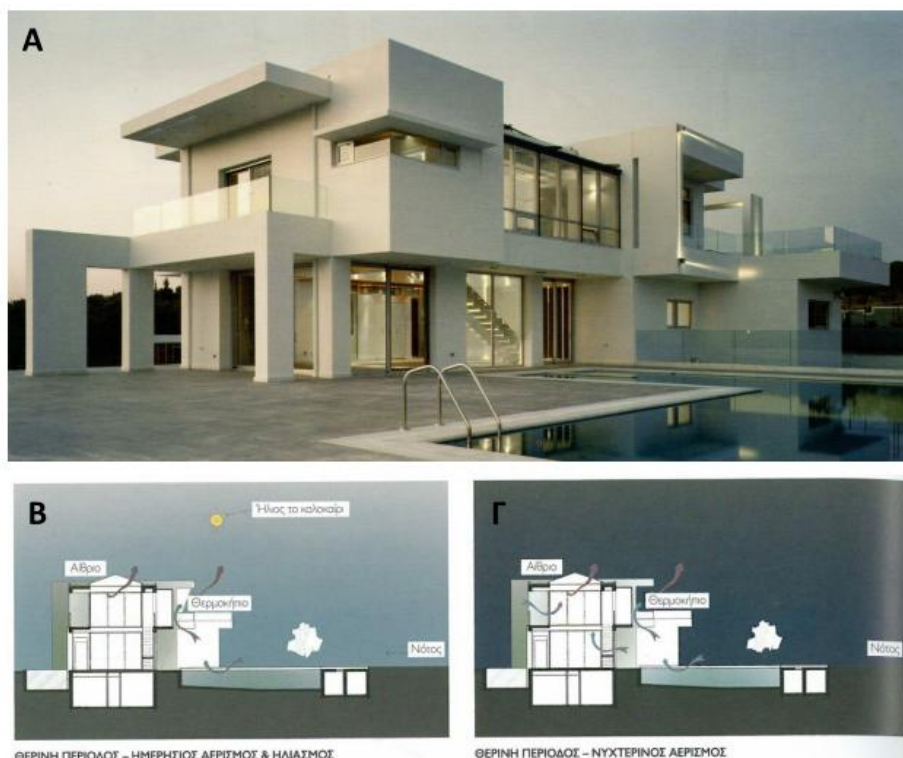
Εικόνα 22. Α. Οι προεξοχές και οι όγκοι που διαμορφώνουν την κατοικία καλύπτουν τις ανάγκες σκιασμού των ανοιγμάτων, Β. Απεικόνιση του ημερήσιου αερισμού και ηλιασμού και Γ. Απεικόνιση του νυχτερινού αερισμού στη βιοκλιματική κατοικία στο Ηράκλειο.
