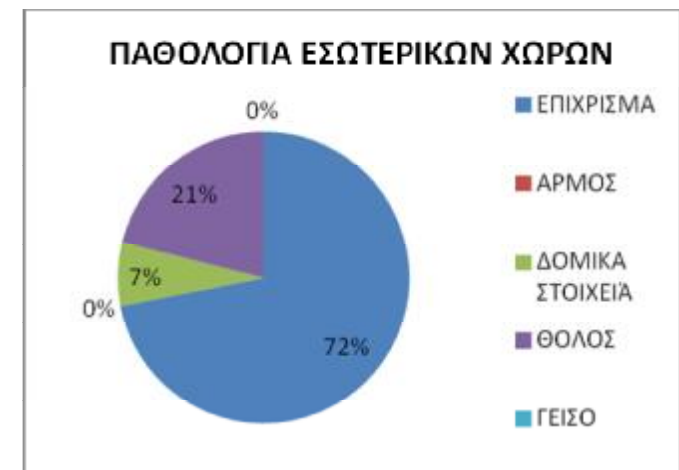
Πίνακας 4: Στατιστική ανάλυση παθολογίας εσωτερικών χώρων του κτιρίου.
