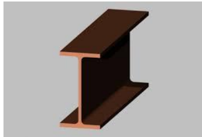
Εικόνα 19: 3D άποψη διατομής χάλυβα διπλού ταυ
