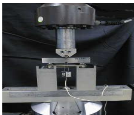
Εικόνα 15: Δοκιμή λυγισμού του χάλυβα
