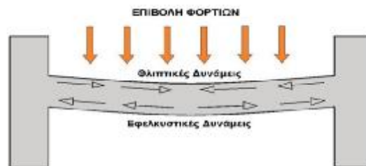
Εικόνα 29: Παραμόρφωση δοκού ύστερα από επιβολή φορτίων
