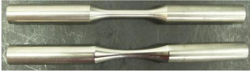
Εικόνα 30: Χαλύβδινα δοκίμια παραμορφωμένα ύστερα απο δοκιμή σε εφελκυσμό
