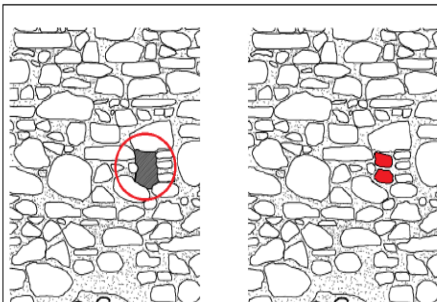
Εικόνα 39: Πλήρωση τοιχοποιίας με λίθους.
