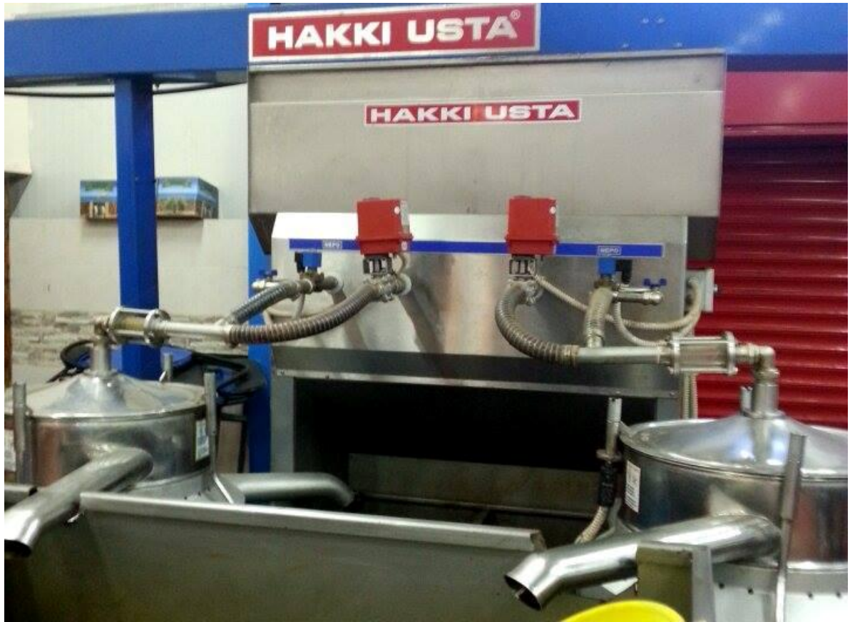
Εικόνα 3: τελευταίο στάδιο διαχωρισμού λαδιού από το νερό
