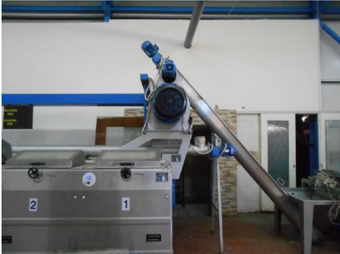
Εικόνα 2: Μεταφορική ταινία όπου ο καρπός μετακινητέ στο σπαστήρα Πηγή: Ελαιοτριβείο Ξανθός
