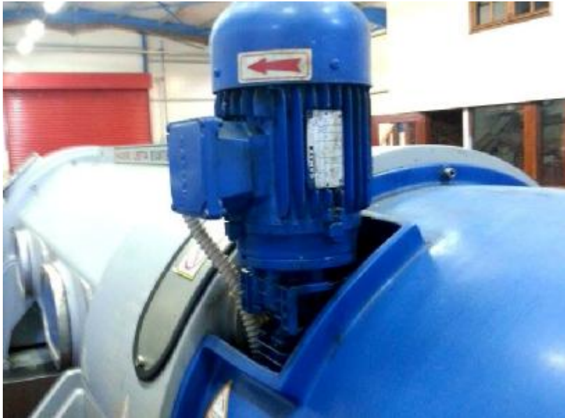
Εικόνα 22 : φυγοκεντρικό ντικάρτερ για τον προτελευταίο στάδιο παραγωγής ελαιόλαδου Πηγή : Ελαιοτριβείο Ξανθός
