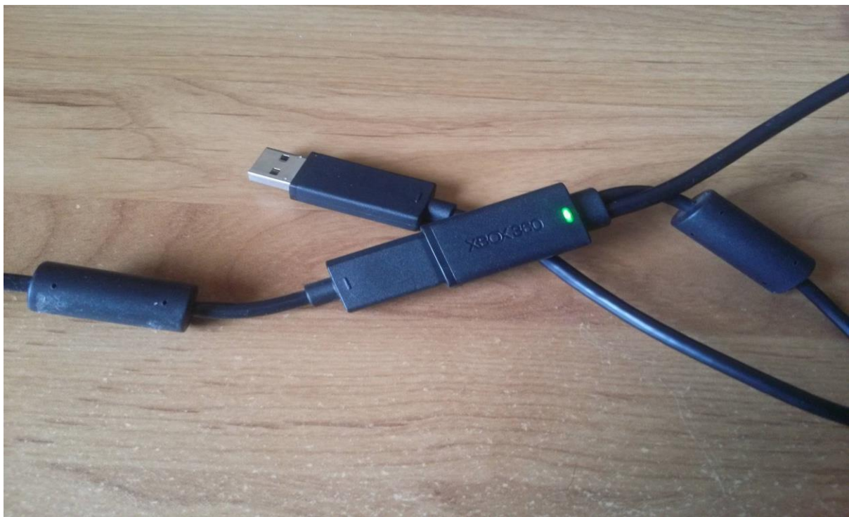
Εικόνα 39: Ο ανάπτορας σύνδεσης του τροφοδοτικού του Kinect με τον αισθητήρα και η usb έξοδος για την σύνδεση με τον υπολογιστή ή το Xbox.
