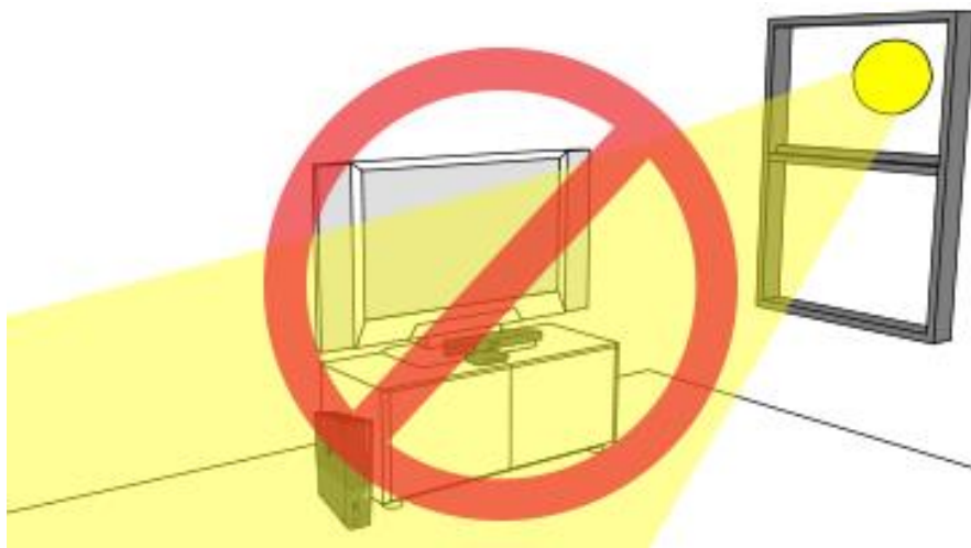
Εικόνα 37: Καλό είναι να αποφεύγεται το άμεσο ηλιακό φως στον αισθητήρα
