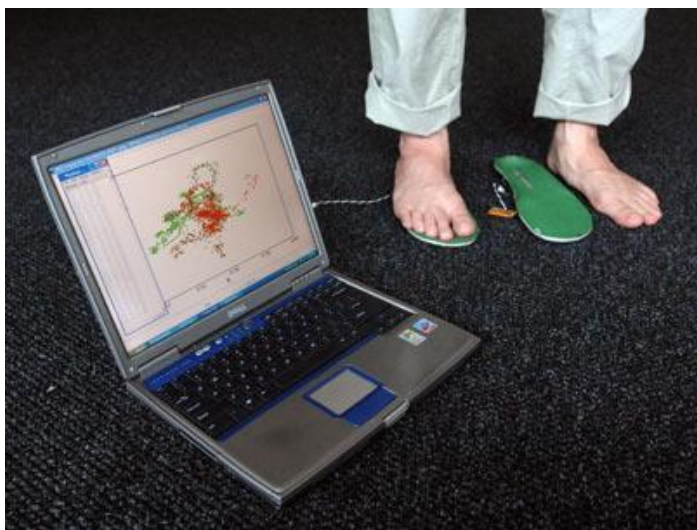
Εικόνα 27: Σύστημα πρόληψης πτώσεων με αισθητήρες στα παπούτσια (Τροποποιημένη από την Atlas5D)
