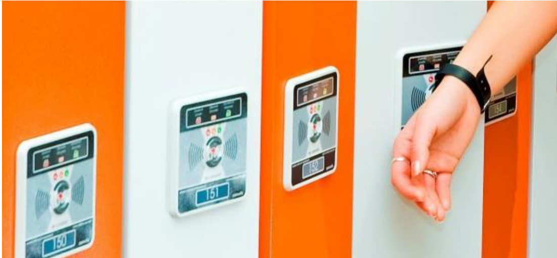
Εικόνα 8: Κλειδαριά με τεχνολογία RFID
