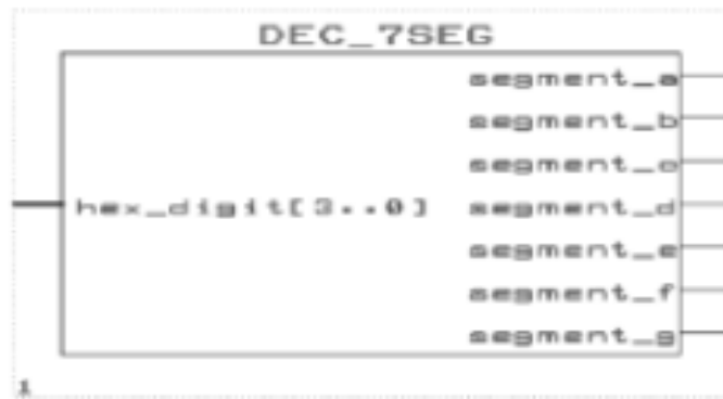
Σχήμα 45 FPGAcoreDEC_7SEG: Hex to Seven-segmentDecoder
