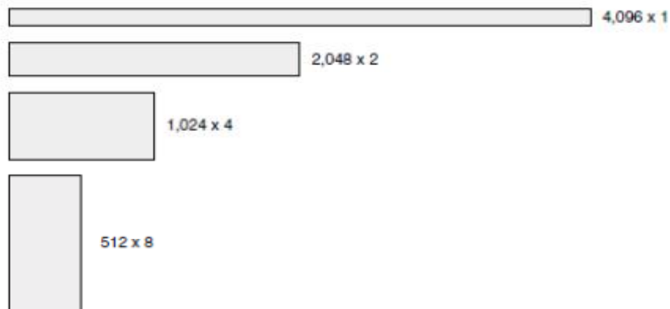
Σχήμα 29 Διαμορφώσιμο FPGA RAM 4 KB block
