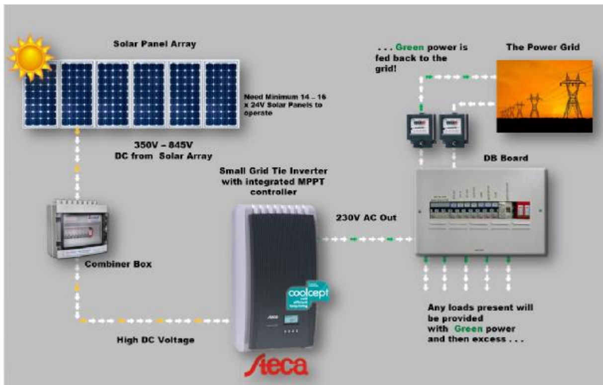
Εικόνα 3.2 Inverter συνδεδεμένος με το ηλεκτρικό δίκτυο χωρίς συσσωρευτές
