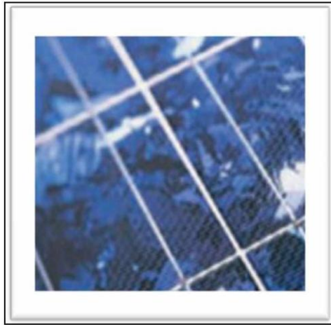
Εικόνα 2.5: ΦΒ στοιχεία πολυκρυσταλλικού πυριτίου
