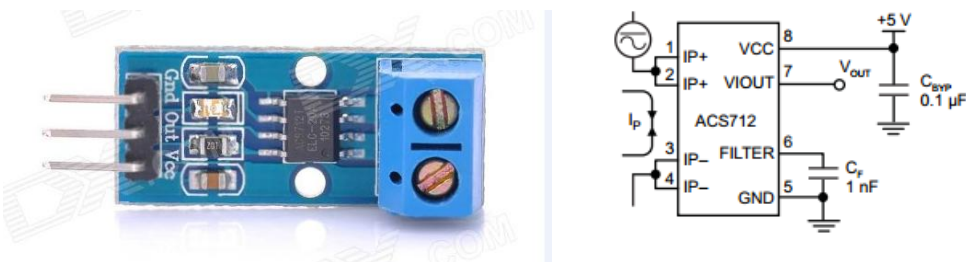
Σχήμα 2.12 – Ο αισθητήρας ρεύματος ACS712, τυπικό διάγραμμα.
