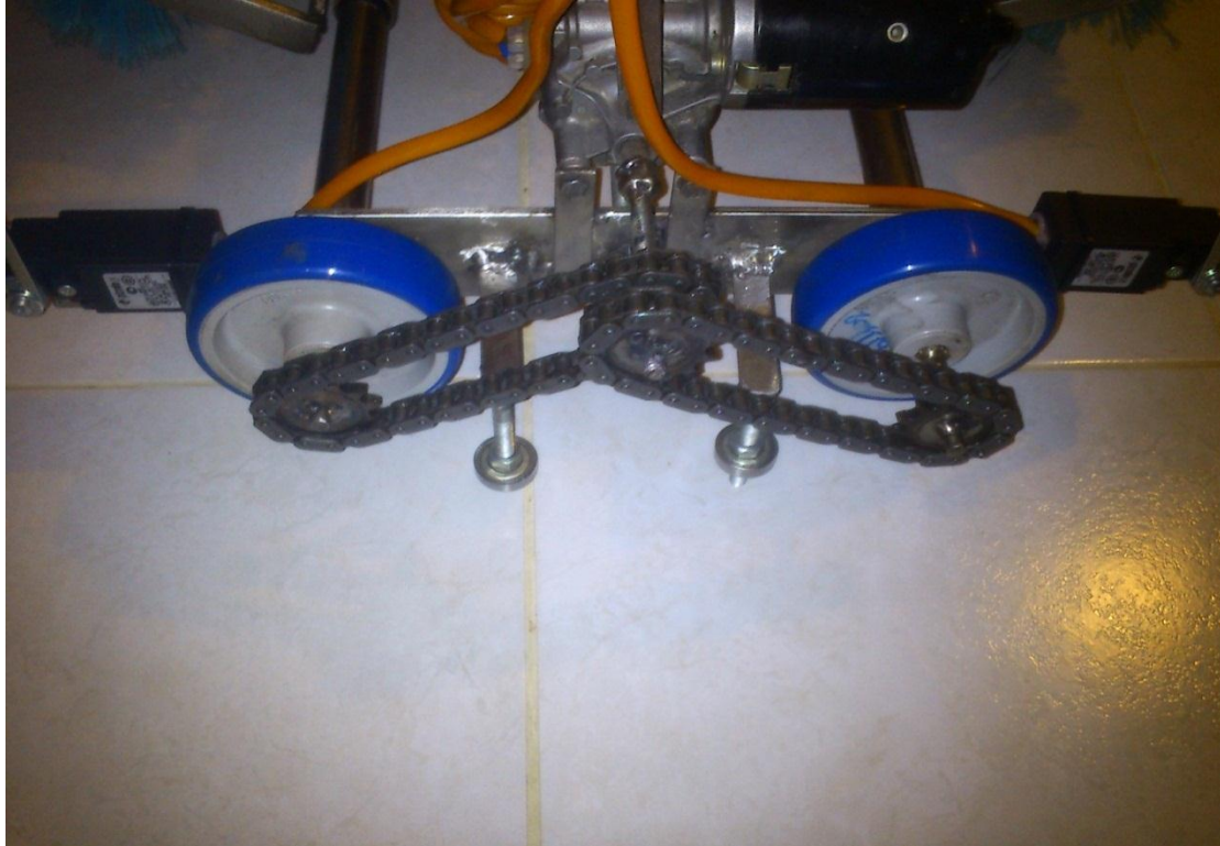
Σύστημα μετάδοσης κίνησης δεξιάς και αριστερής των σκουπών
