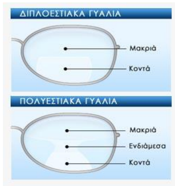
Εικόνα 10: Εστίες διπλοεστιακών γυαλιών (πάνω), Εστίες πολυεστιακών γυαλιών (κάτω)
