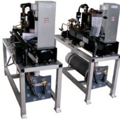
Σχήμα 3.29 - Εναλλάκτης θερμοκρασίας- αντλίες θερμότητας- δεξαμενές εφοδιασμένες με θερμοστάτες κι θερμαντήρες τιτανίου- αντλία θέρμανσης-ψύξης από τιτάνιο
