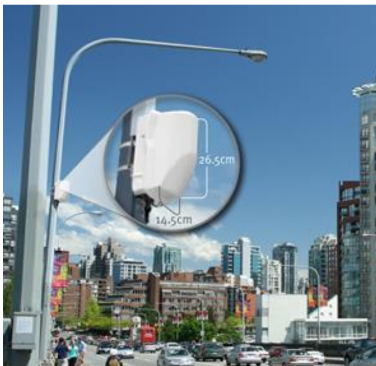
Εικόνα 5: StreetNode Σε Πυλώνα Φωτισμού.
