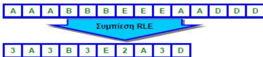
Σχήμα 2.1 : Παράδειγμα κωδικοποίησης RLE
