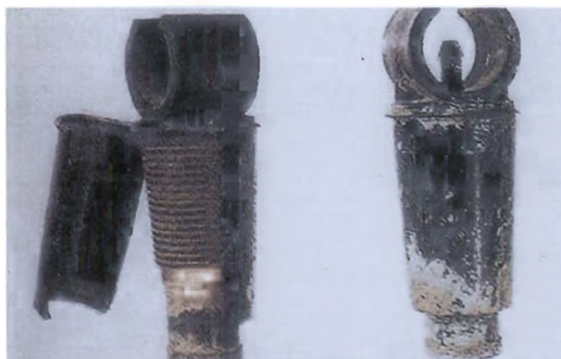
Εικ. 3.1 Νερά πλούσια σε άλατα δημιουργούν ιζήματα διαφόρων ενώσεων, όπως σιδήρου (αριστερά) ή ασβέστου (δεξιά) στους σταλακτήρες ή μικροτοξευτήρες.
