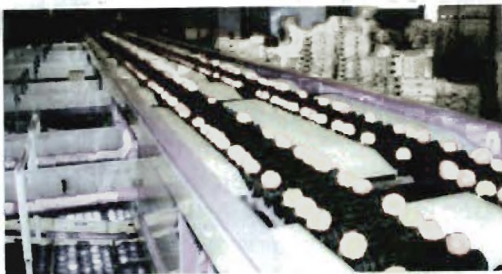
Ηλεκτρονικός Ταξινομητής ροδακίων, νεκταρινιών, βερύκοκων
