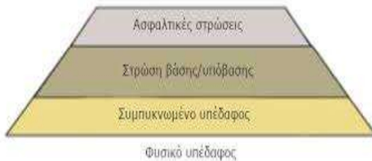
Εικόνα 3.2: Δομή εύκαμπτου οδοστρώματος
