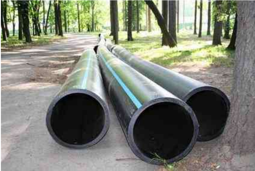
Εικόνα 2.1 Εύκαμπτα τμήματα αγωγών από πολυαιθυλένιο υψηλής πυκνότητας
