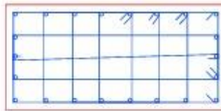
K8 \frac{300 \times 50}{8 \Phi 20 + 20 \Phi 18 - | \Phi 10 / 13 - \Phi 10 / 12} ανά περίοδο
