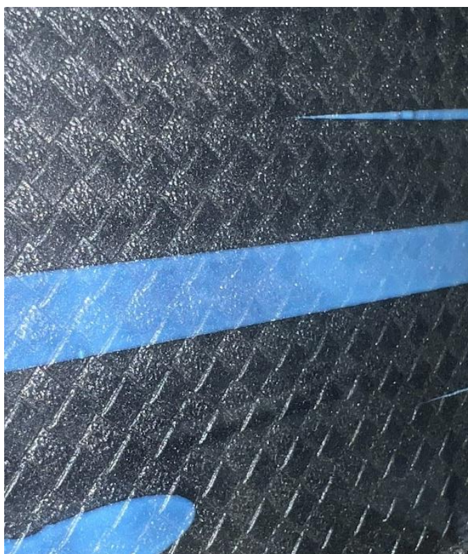
Εικόνα 17: Αποτελέσματα εκτύπωσης στο Test 2 για Διοξείδιο του Τιτανίου ( \text{TiO}_2 )
