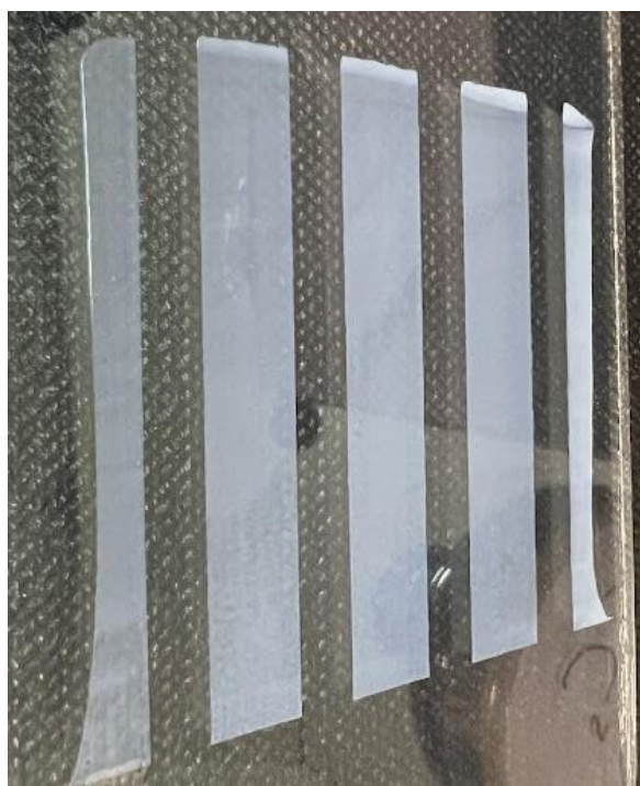
Εικόνα 12: Αποτελέσματα εκτύπωσης στο Test 3 για το διοξείδιο του ζirkονίου ( ZrO_2 )
