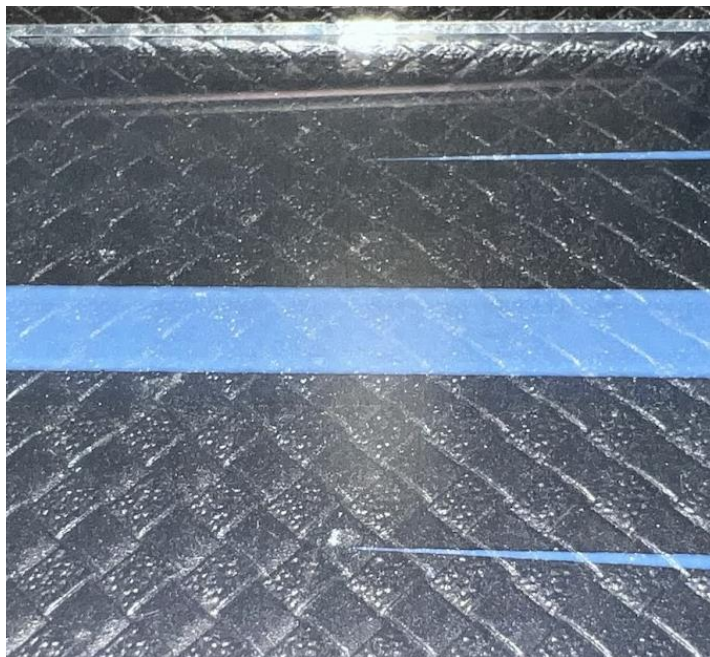
Εικόνα 17: Αποτελέσματα εκτύπωσης στο Test 2 για Διοξείδιο του Τιτανίου ( \text{TiO}_2 )
