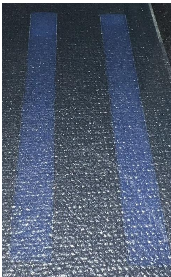
Εικόνα 19: Αποτελέσματα εκτύπωσης στο Test 4 για Διοξείδιο του Τιτανίου ( \text{TiO}_2 )
