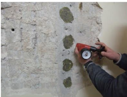
Εικόνα 62: Δοκιμή εξόλκευσης ήλου. (Σιδέρης)
