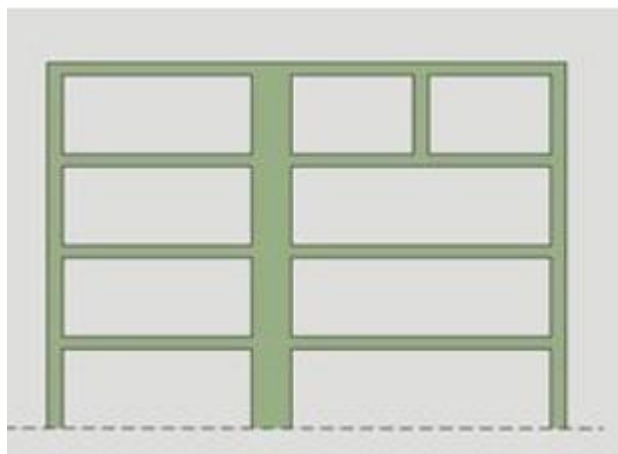
Εικόνα 9: Κτίριο μη κανονικό σε όψη (φυτευτό υποστύλωμα). (Building how 2024)
