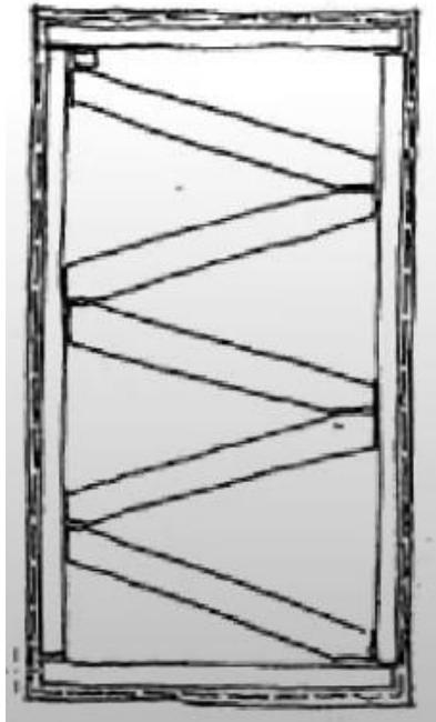
Εικόνα 147: Υποστύλωση που δεν επιτρέπει την είσοδο στο χώρο. (αρχείο Ρουμπιέν Δ.)
