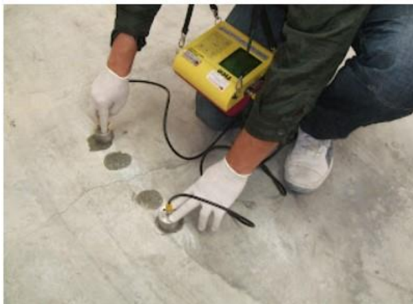
Εικόνα 60: Προσδιορισμός βάθους ρωγμής με υπέρηχο. (Σιδέρης)
