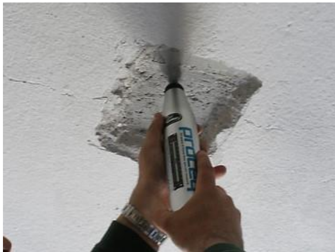
Εικόνα 59: Μέτρηση με κρουσίμετρο. (Βασιλούδας 2017)
