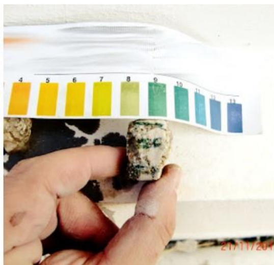
Εικόνα 63: Μέτρηση pH για δοκίμιο σκυροδέματος. (Σιδέρης)
