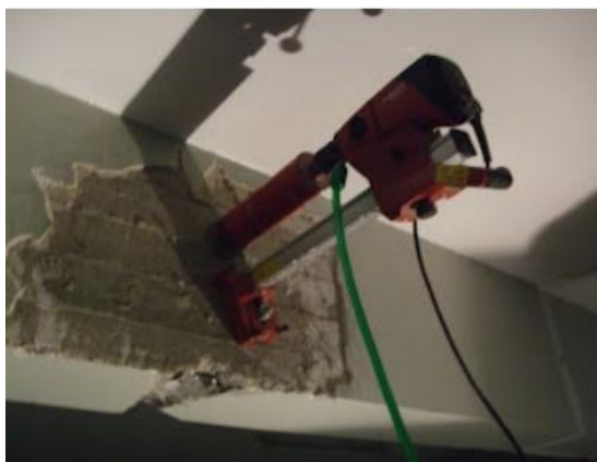
Εικόνα 61: Λήψη κυλινδρικού δοκιμίου από δοκό. (Σιδέρης)
