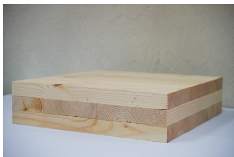
Εικόνα 4.1: CLT τριών στρώσεων από πεύκο. Από Ραϊν Αλεξανδρ Дмитриевич - Έργο αυτού που το ανεβάζει, CC BY-SA 4.0, Πηγή: https://commons.wikimedia.org/w/index.php?curid=65449630 ,
