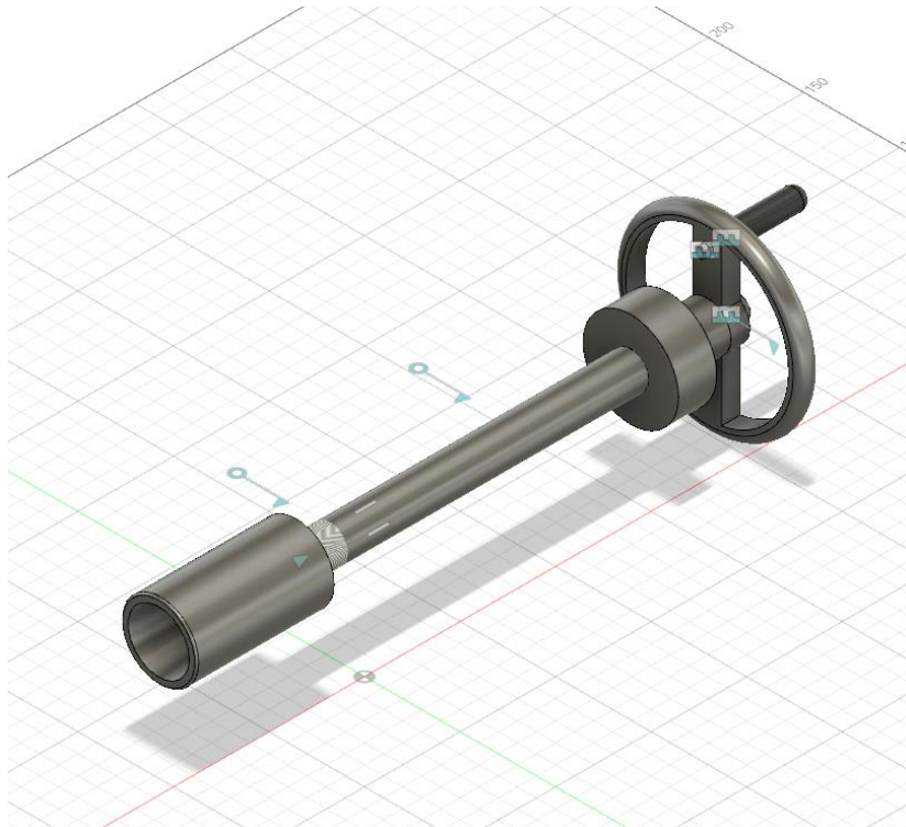
Σχήμα 6.5: Άξονας και τιμόνι κουκουβάγιας από το Fusion360
