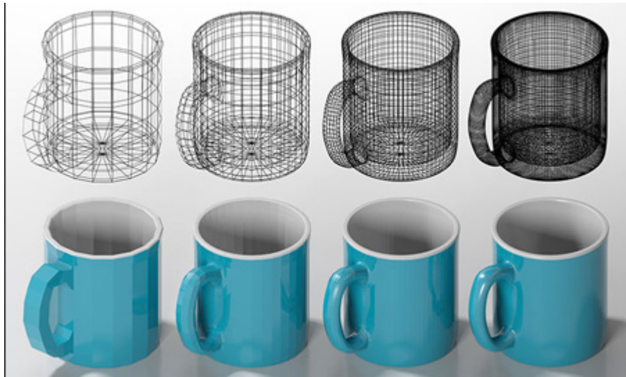
Σχήμα 1.3: Τα διάφορα στάδια της δημιουργία ενός 3D μοντέλου κούπας (φωτογραφία από τη σελίδα thetechnologygeek.org ).
