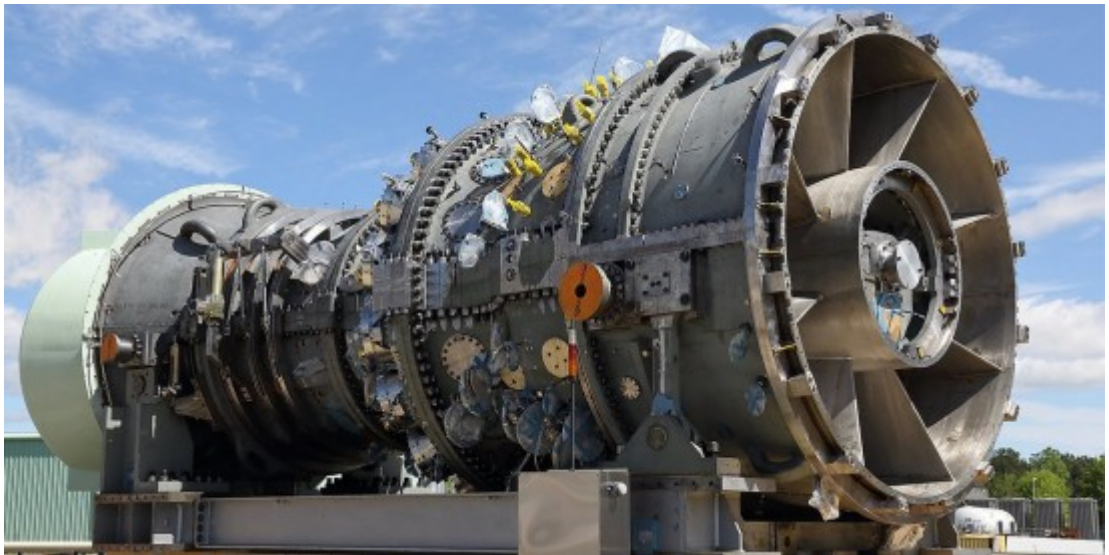
Εικόνα 3-5 Αεριοστρόβιλος που χρησιμοποιείται στο ενεργειακό κέντρο του Αγίου Νικολάου στη Βοιωτία
