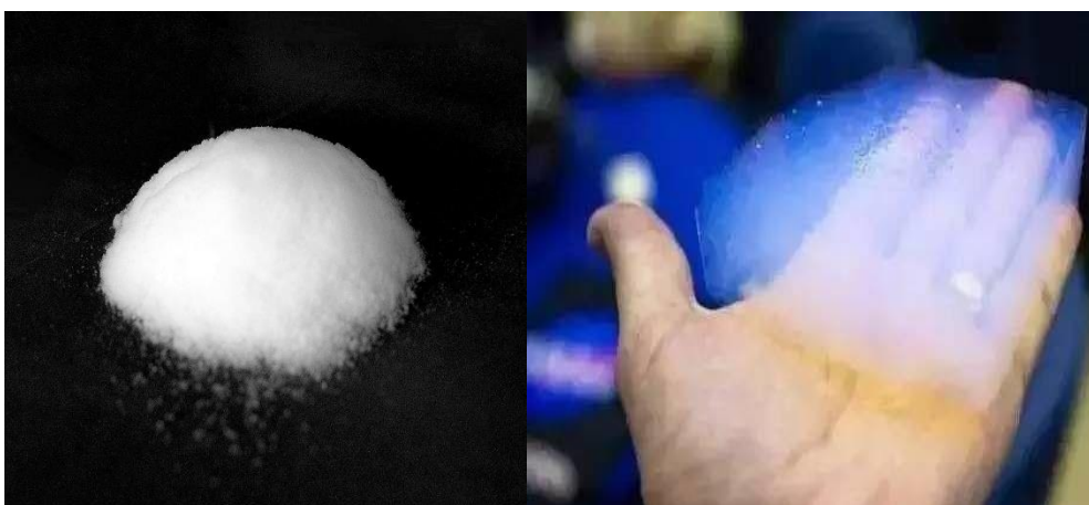
Σχήμα 1.11: Σκόνη αερογέλης πυριτίου 20 nm με 50 nm – Υδροφοβική σκόνη αερογέλης αφής [12]
