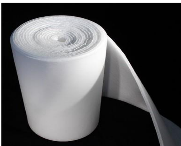
Σχήμα 1.10: Αερογέλη σε μορφή κουβέρτας έτοιμη για χρήση μόνωσης [11]
