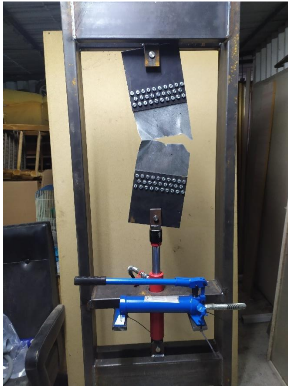
Εικόνα 29. Θραύση δοκιμίου κατά την δοκιμαστική λειτουργία της πειραματικής διάταξης
