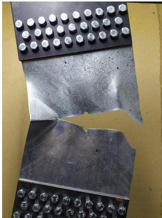
Εικόνα 30. Λεπτομέρεια δοκιμίου μετά τη θραύση
