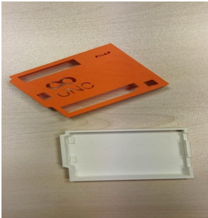
Εικόνα 3.2: Απεικονίζονται τα εκτυπωμένα εξαρτήματα της θήκης του Arduino Uno, τα οποία εκτυπώθηκαν από τρισδιάστατο εκτυπωτή.
