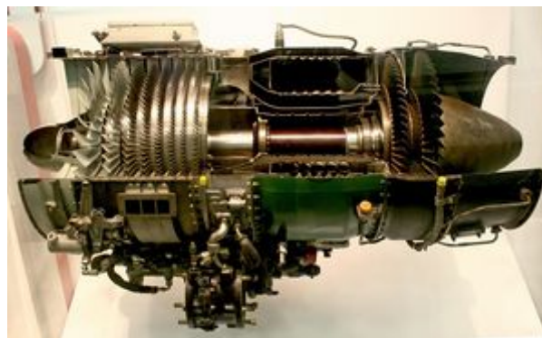
Εικόνα 3.3 Εσωτερικό αεριοστροβίλου ( https://energyeducation.ca/encyclopedia/Gas_turbine )
