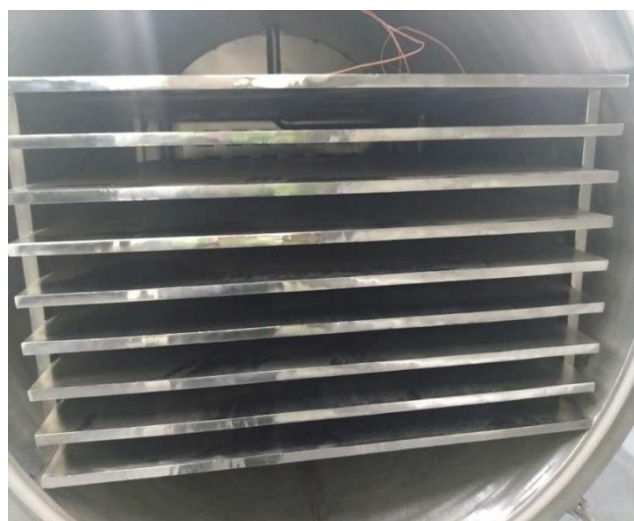
Εικόνα 3.8: Ράφια τοποθέτησης προϊόντων
