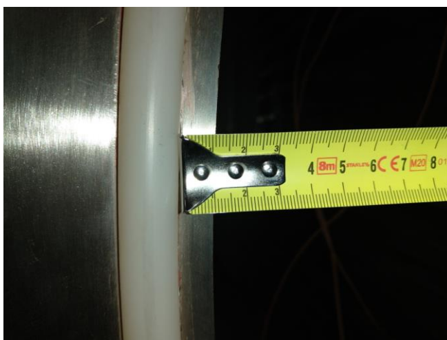
Εικόνα 3.5: Ελαστικό στεγανοποίησης της πόρτας
