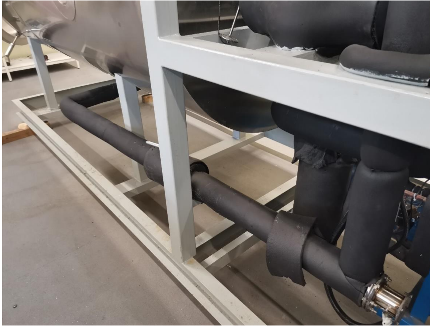
Εικόνα 3.21: Δίκτυο πλήρωσης ραφιών
