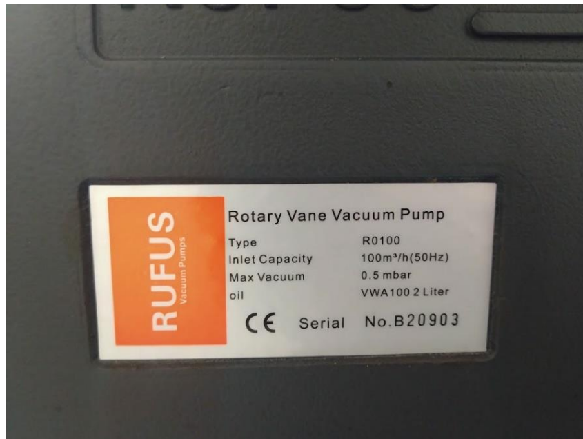
Εικόνα 3.11: Χαρακτηριστικά αντλίας κενού πρώτου σταδίου
