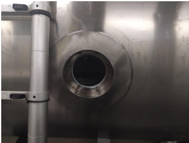
Εικόνα 3.23: Παράθυρο παρατήρησης σωληνώσεων συμπύκνωσης νερού (παγοπαγίδα)
