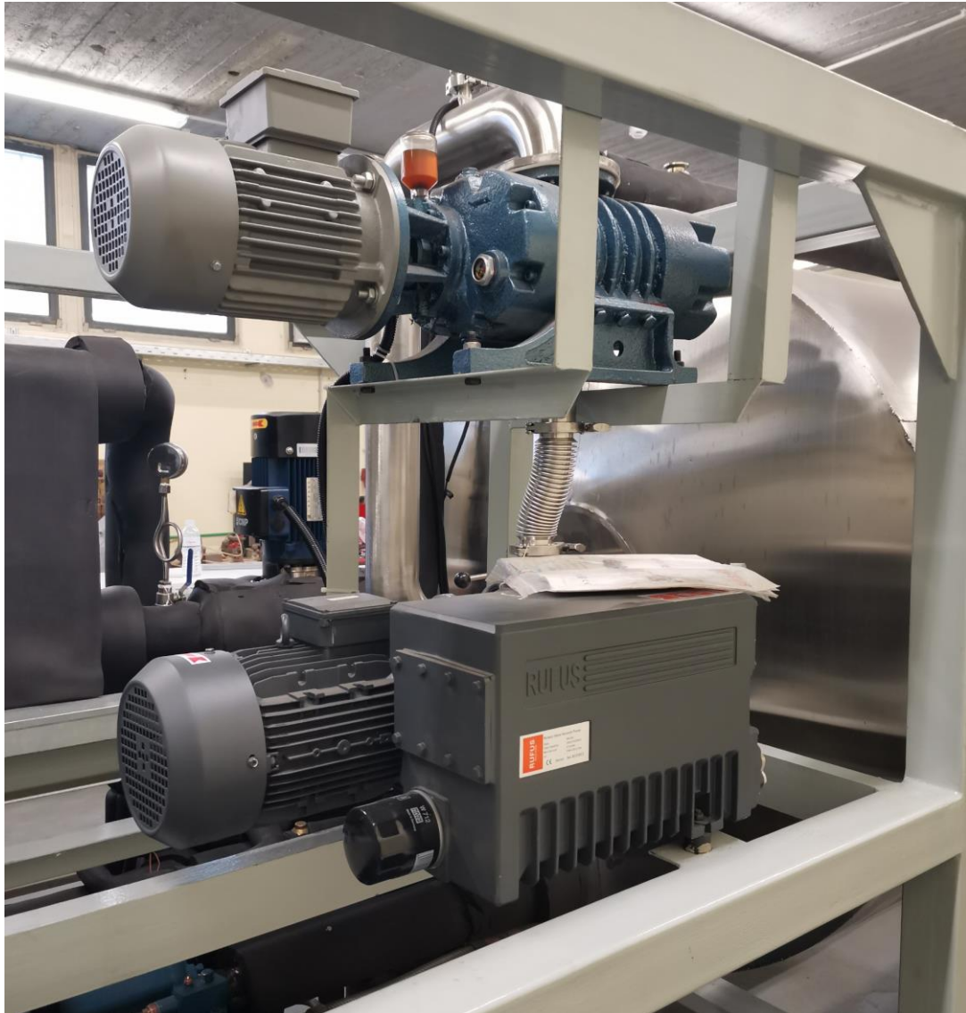
Εικόνα 3.9: Διβάθμιο σύστημα αντλιών κενού
