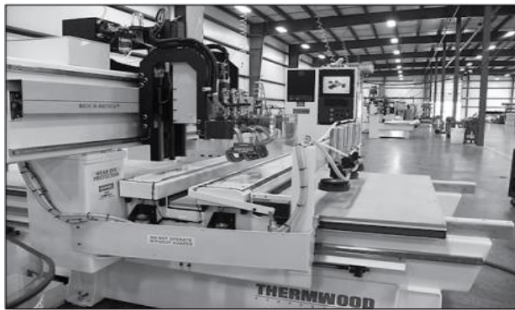
Συγκράτηση κυλίνδρων εφοδιασμένο με αυτόματο φορτωτή φύλλων
